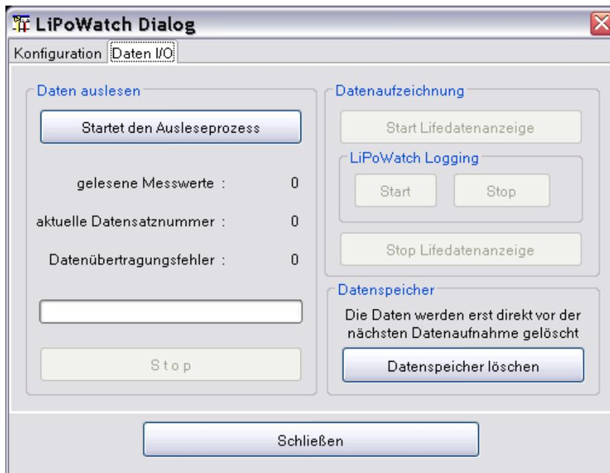
Durch drücken von „Startet den Ausleseprozess“ werden die im Gerät gespeicherten Daten ausgelesen.
