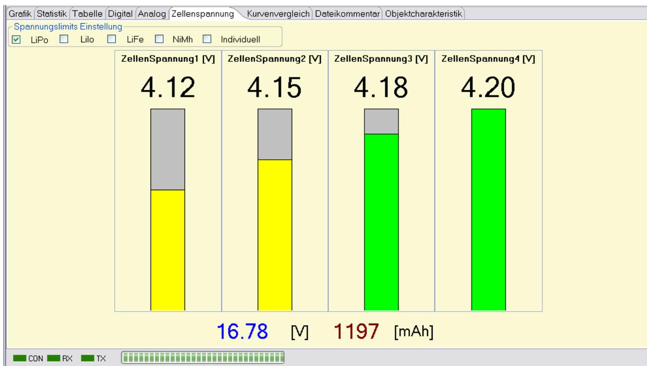
Die Anzeige der Balken wird in Abhängigkeit des Zellentyps, im Beispiel LiPo-Zellen, wenn alle Zellen Spannungen über 4 Volt liegen, über den Anteil der über 4 Volt liegt gespreizt dargestellt. Hat eine Zelle eine Spannung kleiner oder gleich 2,6 Volt bzw. über 4,2 Volt, wird der Balken in rot dargestellt. Bei Zellen Spannungen zwischen 2,6 und 4,2 Volt zeigt sich der Balken in gelb. Beträgt eine Zellen Spannung genau 4,2 Volt, färbt sich der Balken grün.
