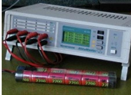
Der AkkuMaster-C4-Gerätedialog dient zum Einstellen und Auslesen von Lade- bzw. Entladevorgängen. Es können alle vier Ausgänge einzeln konfiguriert und bedient werden. Eine Konfiguration, die das Gerät überlastet ist, nicht möglich. Der aus den anwendungsspezifischen Einstellungen resultierende Gesamtstrom wird jeweils angezeigt.
