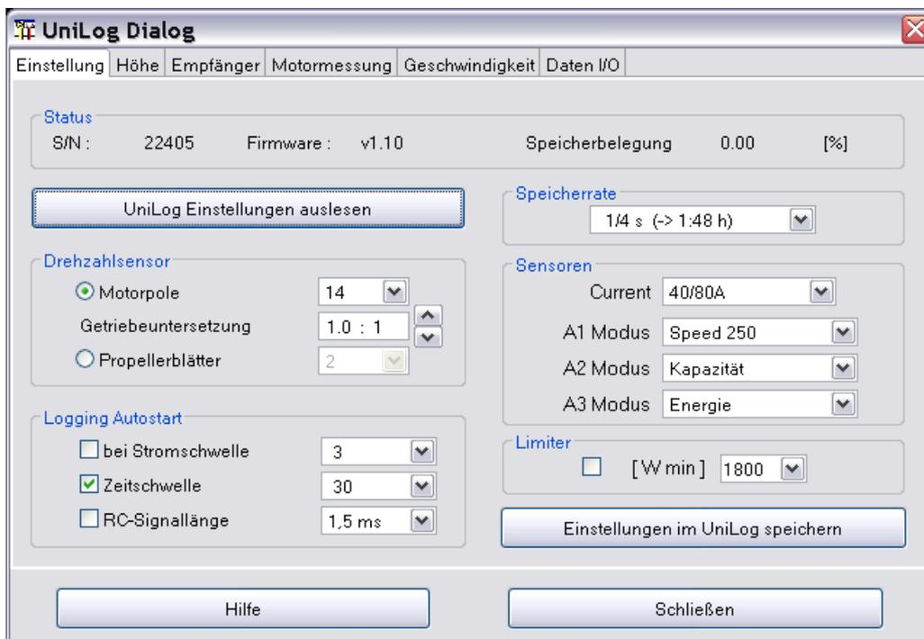
Alle analogen Anschlüsse werden ab Firmware 1.10 vorkonfiguriert. Aktiviert man die „Limiter“-Funktion, wird ab dem eingestellten Leistungsverbrauch das Signal zum Motorregler heruntergeregelt. Hierzu muss natürlich das Reglersignal über den UniLog geschleift werden. Bei „Limiter“-Betrieb wird das Zeitintervall auf 1/16 Sekunde verändert und es ist nur eine Datenaufnahme möglich.
