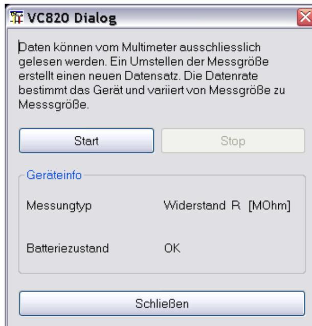
Schaltet man am Gerät die Messgröße um, wird automatisch ein neuer Datensatz angelegt. Durch drücken des „Stop“-Knopfes wird die Datenaufnahme abgebrochen.
