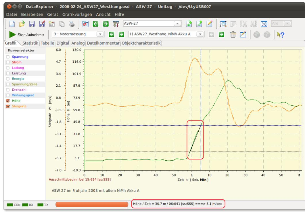
Als Messfadencross werden ein schwarzes und ein blaues Fadencross eingeblendet. Beide werden genau so bewegt, wie bei der Einzelpunktvermessung. Besonders sinnvoll sind solche Messungen im vergrößertem Zustand. Hier wird als Zusatzinformation noch die Anfangszeit des Kurvenausschnittes angezeigt.
