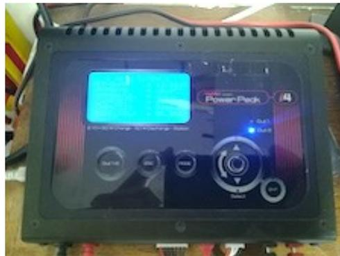
Ein starkes Ladegerät mit einfacher Bedienung, Live-Datenaufnahme über eine serielle Verbindung. Es gibt keinen Gerätedialog.
