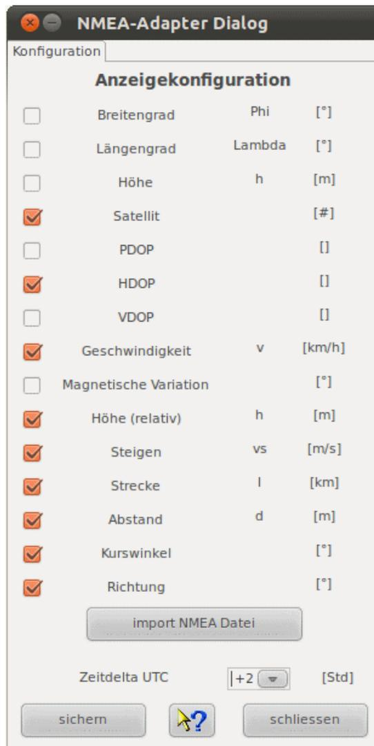
Über die Konfiguration eines Zeitdeltas kann die positionsbezogene Zeitzoneabweichung angepasst werden.
