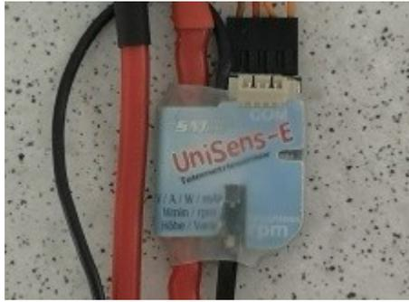
Das UniSens E erlaubt über die serielle Schnittstelle (Adapter erforderlich) Live-Datenaufnahmen zu sichern. Die Funktion ist vergleichbar mit dem UniLog 2, ohne Zellenspannungen.
