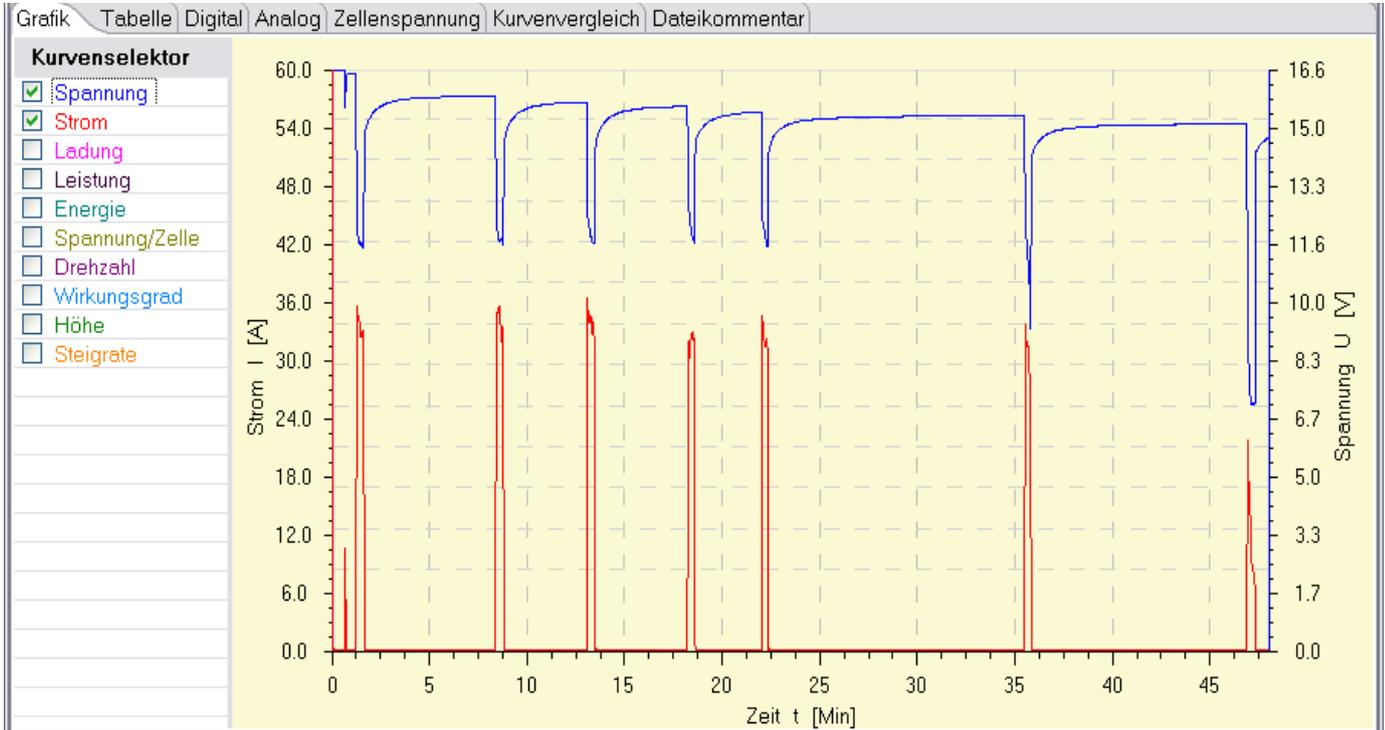
Über die Kurvenauswahl sieht man anhand der Farbübereinstimmung den Zusammenhang zu den gezeichneten Kurven. Die Kurvenauswahl repräsentiert die Kurvenlegende und ermöglicht durch Selektion ein aktiv- bzw. inaktivschalten der Kurven.
