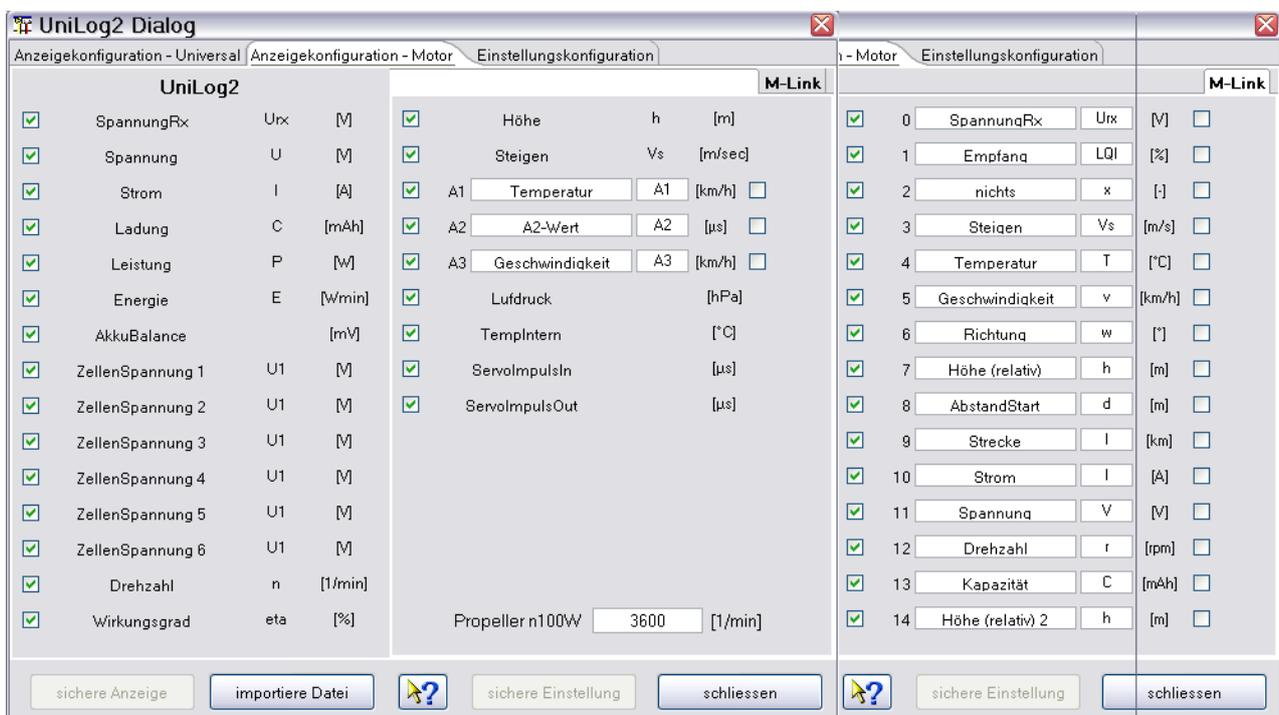
Die Eingabe des Drehzahlwertes, bei dem der Propeller 100 Watt leistet, ermöglicht die Berechnung des Wirkungsgrades. Die Berechnung ist nicht besonders genau, hilft aber bei Vergleichen.
