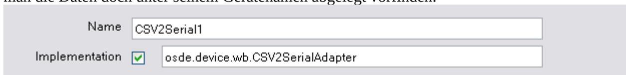
Gibt man das „package“ nicht an, beginnt das „package“ immer mit „`gde.device.`“, gefolgt vom Namen des Herstellers in Kleinbuchstaben umgewandelt, wobei Leerzeichen sowie Bindestriche entfernt werden. Aus dem Gerätenamen wird der Klassenname ebenfalls durch entfernen von Leerzeichen und Bindestrichen berechnet. Die Groß- und Kleinschreibung wird für den Klassennamen allerdings beibehalten.
