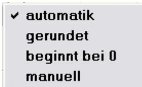
Wählt man **manuell**, öffnet sich ein kleiner Dialog, der die Einstellung der Achsenendwerte erlaubt. Werte können nicht nur durch Selektion verändert werden, sondern durch Eingabe über die Tastatur, also durch Überschreiben. Als Dezimalseparator kann Punkt oder Komma verwendet werden. Drücken der Entertaste oder Selektion des OK-Knopfes schließt die Eingabe ab.
