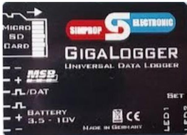
Ein preiswerter Daten-Logger für Multiplex-Serial-BUS Sensoren, der Daten auf einer SD-Karte schreibt. Diese Karte kann man über einen passenden Adapter an eine PC anschließen und die Dateien über „Import“ zur Auswertung bringen.
