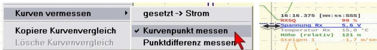
Den Messpunkt kann man auch direkt bei gedrückter Shift-Taste und linker Maustaste setzen. Dabei wird der Messwert gewählt dessen Kurve sich am nächsten zum Mauszeiger befindet.
