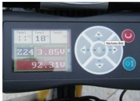
Der 4D-Akkumonitor wird zum Aufnehmen von Akku- und Einzelzellenüberwachung im Rennsport verwendet. Realisiert über den Import von Komma separierten Daten werden neben den Zelleneinzelspannungen Rundenzeiten und GPS-Daten ausgewertet.
