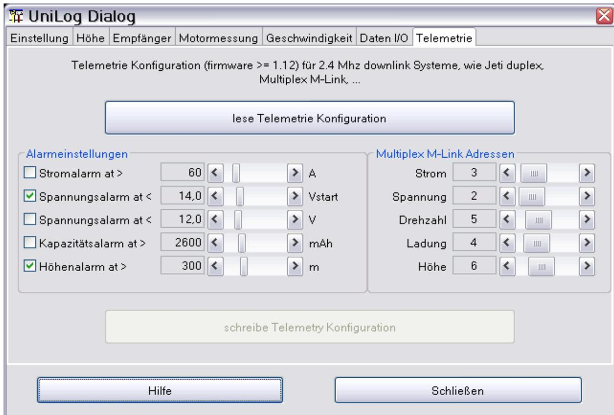
Wird eine Einstellung verändert, wird auch der Knopf freigeschaltet, der ein Übertragen der veränderten Telemetriedaten in das UniLog ermöglicht.
