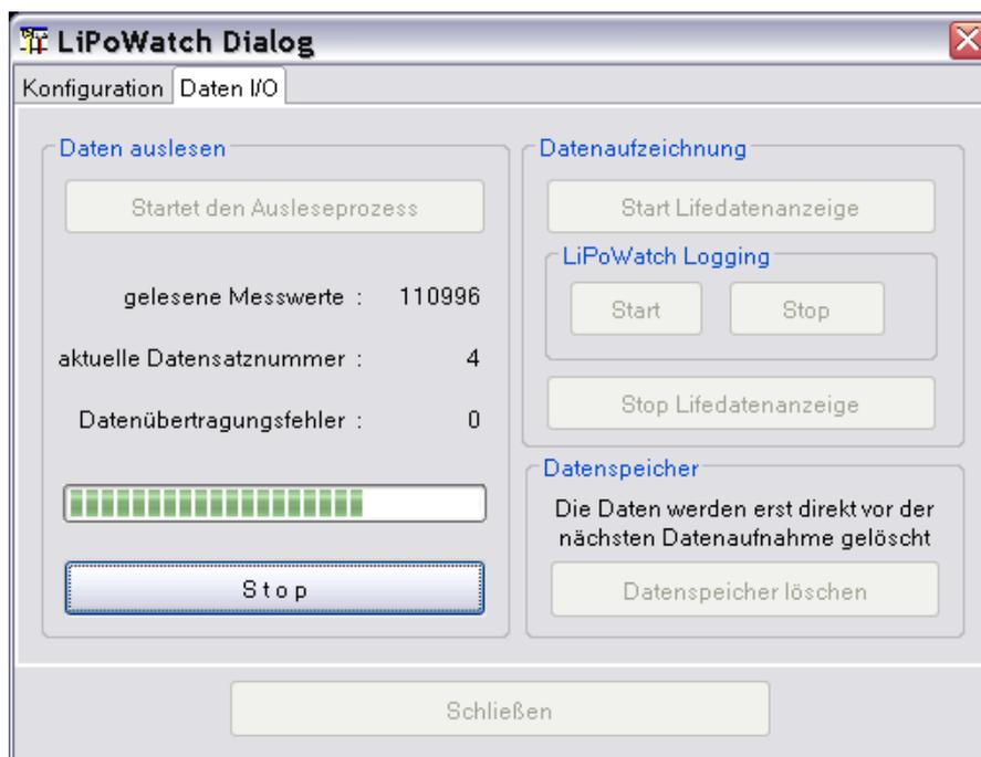
Am Ende der Datenübertragung werden die Messdaten aufbereitet und angezeigt. Der Dialog ist dann wieder im initialen Zustand, nur der Fortschrittsbalken ist gefüllt und die Anzahl der ausgelesenen Messdaten wird angezeigt.
