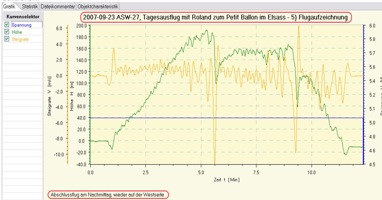
Zum Datensatzkommentar. Auch hier gilt, die eingeblendete Zeispricht der Zeit, zu der der Datensatz eingelesen wurde. Die Zeitmarke dient als Anhaltspunkt und kann überschrieben werden. Dieser Kommentar dient dazu, Dinge zu notieren, die datensatzspezifisch sind, z. B. besondere Ereignisse oder Bedingungen, die diesen Datensatz von anderen unterscheidet.
