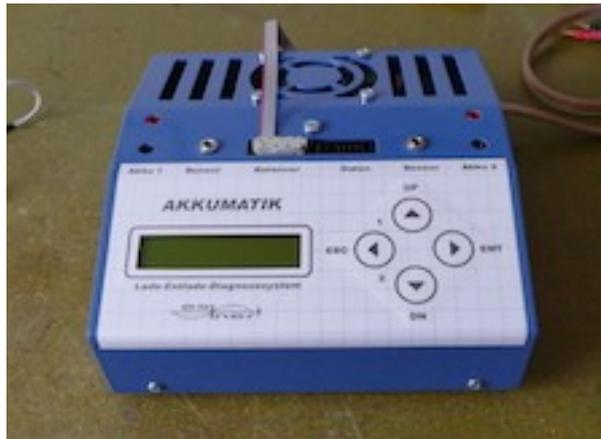
Ein qualitativ hochwertiges Ladegerät, dass es auch als Selbstbaulösung gibt mit ausgezeichneten Werten. Das Gerät unterstützt lediglich das Auslesen von Werten, es kann kein Ladeprogramm am Rechner erstellt und an das Gerät gesendet werden.
