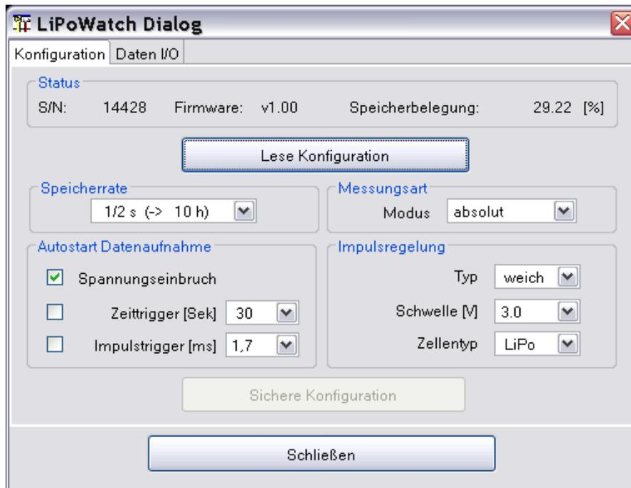
Werden Einstellungen verändert, wird „Sichere Konfiguration“ aktiv. Durch drücken werden die gewählten Einstellungen in das LiPoWatch geschrieben.
