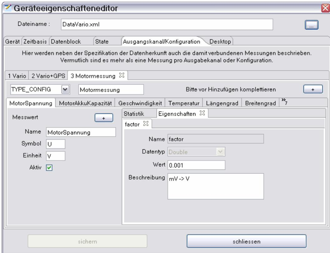
**Hinweis:** Benötigt man weitere Eigenschaften oder Statistikeinstellungen kann man diese durch das Kontextmenü anfordern. Nach der Vervollständigung kann man dann die gerade fertiggestellte Messwertkonfiguration in eine Neue, durch Selektion des „+“-Knopfes, kopieren.
