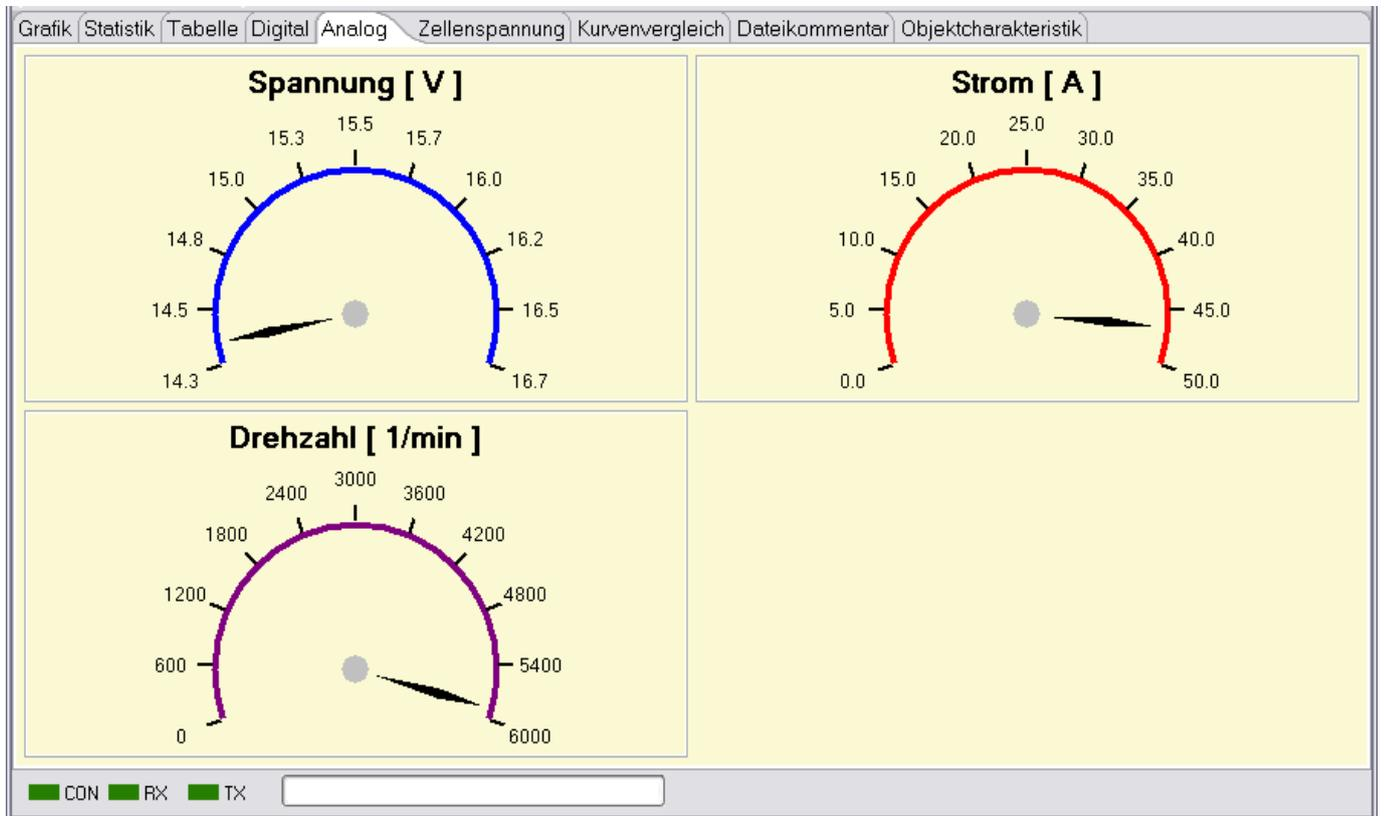
Da diese Anzeige nur während der Live-Datenaufnahme verändernde Werte anzeigt, kann man die Anzeige für jedes Gerät im Geräteauswahldialog stilllegen, wenn dieser Tabulator stört (siehe [Desktopkonfiguration](#)).
