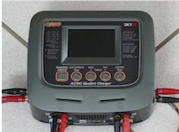
Das Q200 ist ein preisgünstiger Ladegerät mit vier unabhängigen Ausgängen. Wie in der Bedienungsanleitung angegeben, wird eine vor dem Ladevorgang durchgeführte Messung des Innenwiderstandes, dieser Ri-Wert in die ausgelesenen Daten übernommen. Deshalb ist es ratsam, möchte man diesen Wert im Auge behalten so eine Messung mit dem bereits angeschlossenen Akku vor dem Starten des eigentlichen Ladevorganges durchzuführen.
