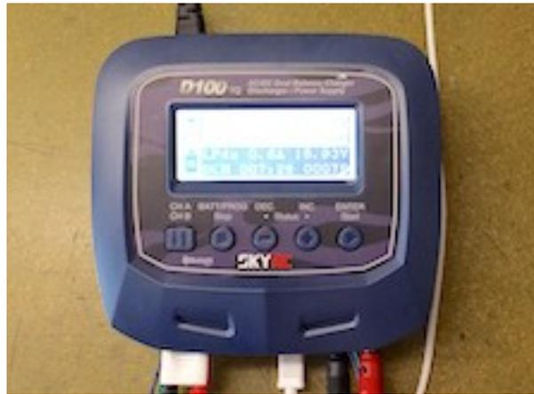
Das D100 ist ein preisgünstiger Ladegerät mit 2 unabhängigen Ausgängen. Mit der aktuellen Firmware des Gerätes wird nicht, wie in der Bedienungsanleitung angegeben, eine vor dem Ladevorgang durchgeführte Messung des Innenwiderstandes, dieser Ri-Wert in die ausgelesenen Daten übernommen. Das wird sich voraussichtlich mit neuerer Firmware ändern.
