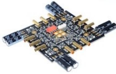
Die Herkules III Telemetrie-Daten vom für Quadrocopter spezialisierten Treiberplatine folgen der CSV Notation. Es werden Regler- und Batterie-Zustände genau aufgezeichnet.
